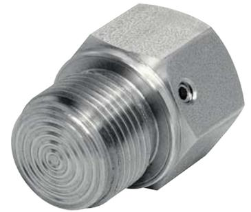
Utilisés pour isoler l'élément sensible des manomètres DN63, pressostats et transmetteurs électroniques de pression, des fluides de process corrosifs, visqueux, sédimenteux ou d'une température élevée. La membrane soudée et testée garantit la séparation du fluide de transmission de celui du process. La construction de ces appareils en permet l'utilisation chaque fois que les dimensions réduites et que la rapidité de nettoyage lors de manipulations fréquentes est importante.
